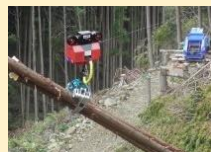
自動で集材する架線集材機
