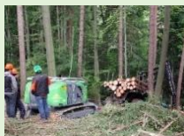
ワイヤサポートを使用し、斜面を走行する運材車
