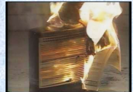
電気ストーブに新聞紙が接触した場合の実験
