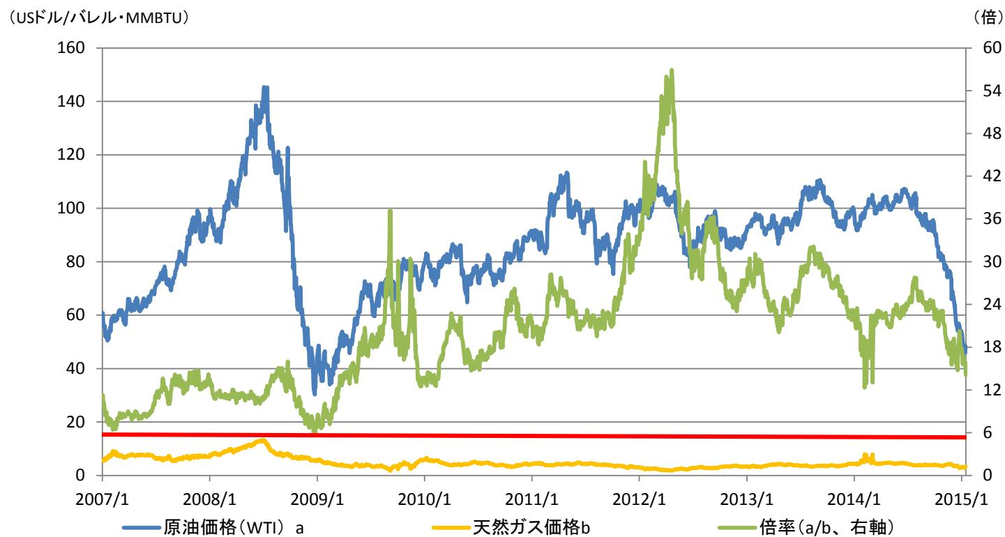
(注)赤線(右軸)は、原油(1バレル)と同熱量となる天然ガス(MMBTU)の量で概ね5.8MMBTU(5.8倍)。価格差の理論倍率ともいえる
