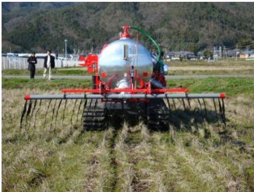
ゴムクローラー液肥散布機により、散布しながら圃場を自走する。
