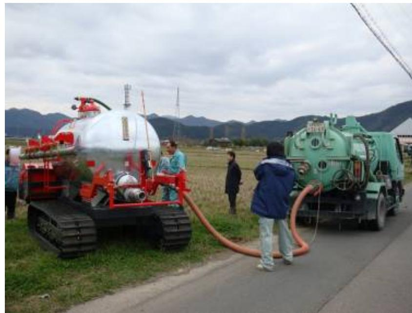
南丹市八木バイオエコロジーセンターから散布圃場まではバキュームカーで液肥を運搬し、圃場で液肥散布機に液肥を乗せ変える。
